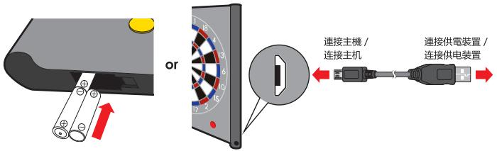
· 請按照安裝導覽，將鏢靶安裝在正確的位置，並插上 USB 連接線，按下 開啟電源。
