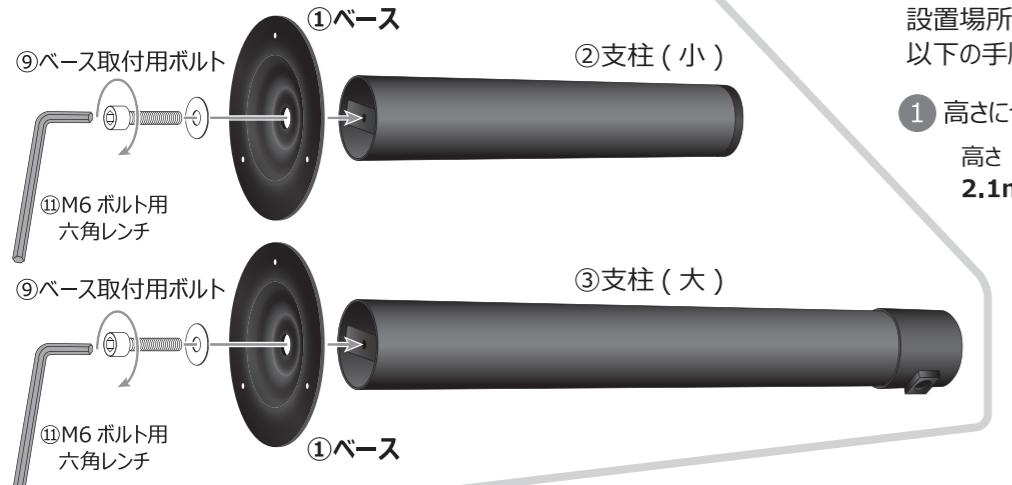
2 支柱を仮組立する(表面;「設置場所の天井高さ毎の寸法の目安」をご覧ください。)
